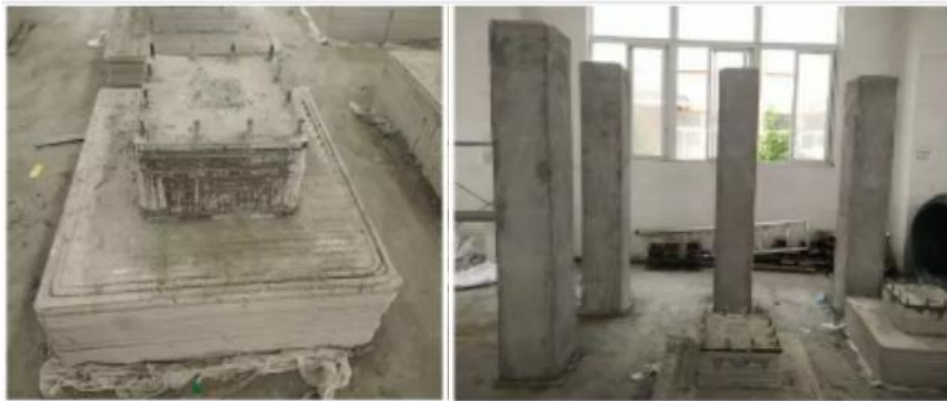
a) 景观亭基础 3D 打印制作
