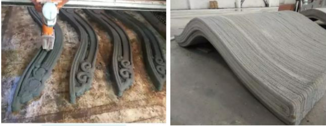
c) 景观桥 3D 打印制作
