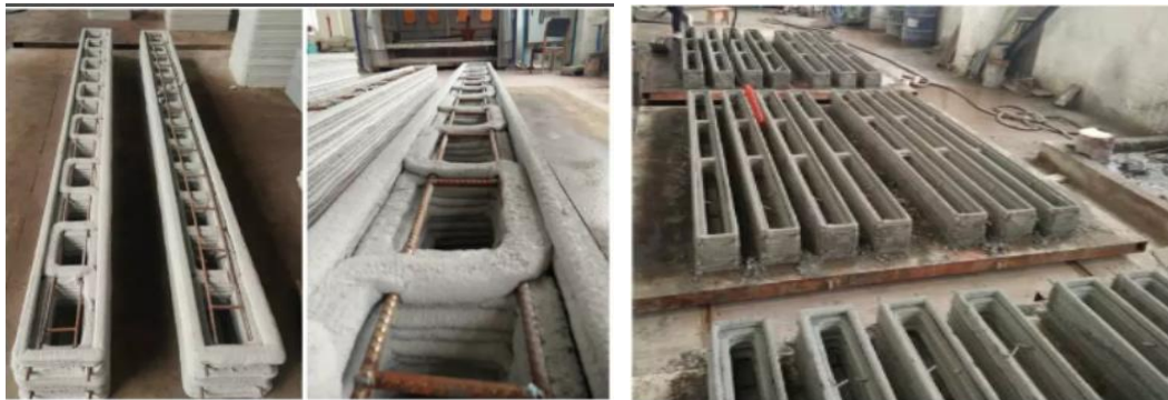
b) 景观连廊柱 3D 打印制作
