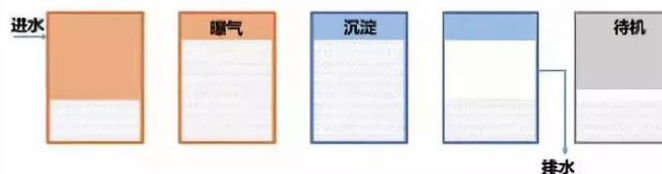
图12 SBR池工作时间进程
